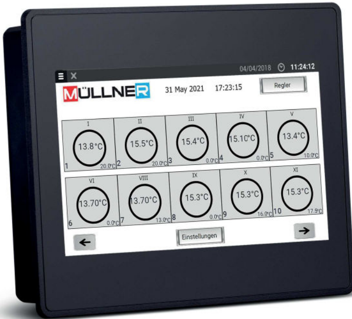
Vor Ort wird die Weintank-Temperatur auf den sieben Zoll großen TFT Widescreen Displays der eSmart107 HMIs angezeigt.
